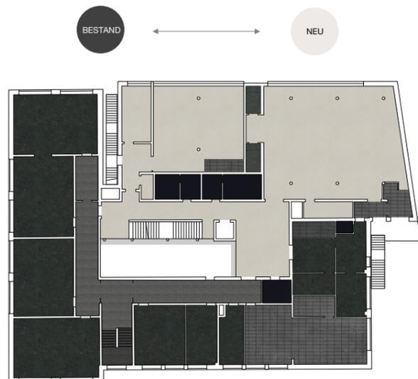
Bodenbeläge in Bestand und Neubau 1. Obergeschoss
